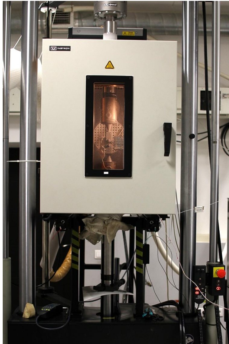
Рисунок 27 – Общий вид испытательной машины Instron 8802 для испытания на рост трещины при комнатных, повышенных и пониженных температурах с применением метода АЭ
