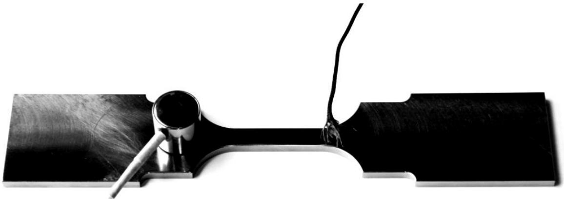
Рисунок 23 – Образец для испытания на одноосное растяжение с установленными на нем АЭ сенсором и термопарой
